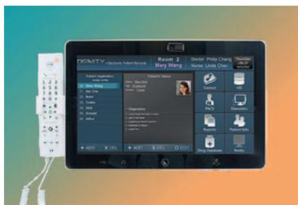
Atom Z3735F, er taktet mit 1,33GHz und unterstützt maximal 2GB DDR3L Speicher. Für das Betriebssystem und Nutzerdaten eignet sich die integrierte eMMC-Karte. Hinsichtlich der I/O-Optionen bietet das Gerät folgende Ausstattung: 3 x USB 2.0, 1 x Micro USB, 2 x Stereo Phone und 1 x Digital Mic. Optional erhältlich sind noch PoE, RFID, WLAN und Multimedia Handset. Die Audio-wiedergabe wird vom Realtek ALC5645-Chip übernommen, die Tonausgabe erfolgt über zwei 3-W-Lautsprecher.
