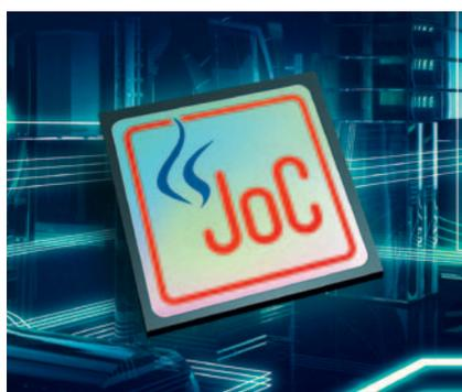
des JoC-Managers enthält eine komplette Java-Entwicklungsumgebung. Applikations-Upload, Debugging und Test werden über die USB-Schnittstelle des Chips durchgeführt.
