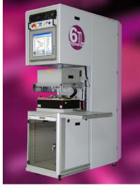
XJTAG バウンダリスキャンテスタで製造検査システムのプラットフォームを機能強化 **for** Engineering 社は、検査機能をモジュールで拡張できる製造検査システムに、XJTAG バウンダリスキャンテストシステムを採用。LabVIEW™で効率良く統合ができて、コストパフォーマンスに優れていることから、受託製造企業やOEMに活用されている。
