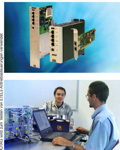
XJTAG wird zum Testen von ETELs-Antriebssteuerungen verwendet
