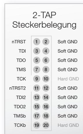
Im Idealfall wird jedes neue Design den gleichen Steckverbindertyp und das gleiche Signallayout verwenden, so dass die Kabel wiederverwendet werden können. Diese Anschlüsse sollten „kodiert“ werden, um eine Fehlausrichtung zu vermeiden.
