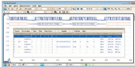
串行协议分析仪具有大容量存储功能，可以捕捉数千帧的连续数据。目前包括的协议有CAN总线，I2C，SPI，RS232和UART。你可以使用不同的格式来显示解码的数据：如“in view”，“in window”或者同时显示这两种格式。你可以放大这些帧去查找波形上的干扰和失真。“in window”格式可以显示被解码的帧的列表，包括数据，所有的标志和标识符。你可以设置过滤条件去筛选数据帧，也可以寻找具有某些特殊属性的帧，或者定义一个启动模板来启动程序列出数据。你还可以创建一个电子数据表，把十六进制数据解码成纯文本。
